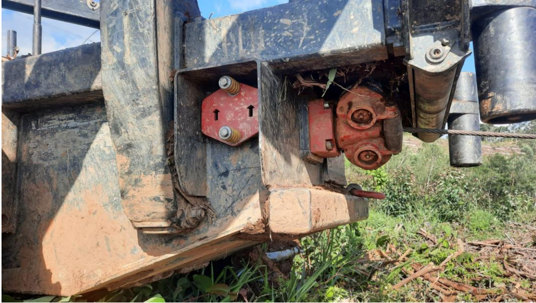
Figura 10: Guincho de tração auxiliar HERZOG HSW9-S1 – equipamento utilizado no estudo.
