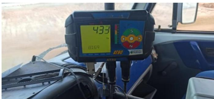
**Imagem 24.** Painel com balança na cabine do caminhão. Fonte: Arquivo pessoal.
