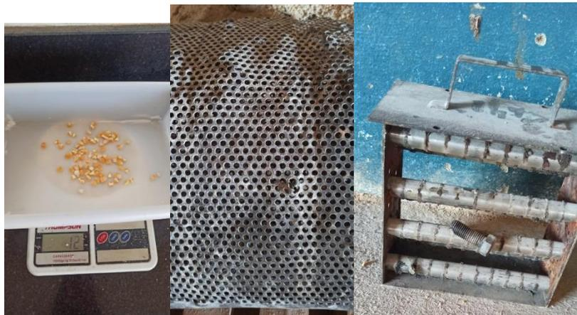
**Imagem 14.** A esquerda grãos de milho inteiro pesados na balança. No meio Peneira o moinho de milho com perfurações e amassos e na direita o imã colocado no moinho de milho. Fonte: Arquivo Pessoal
