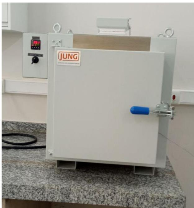
Legenda – Forno resistivo do tipo Mufla com abertura frontal.
