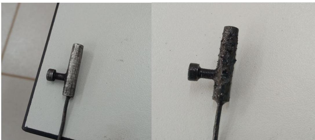
Legenda – Sonda utilizada para coleta de dados. A direita, sonda limpa antes do processo de coleta de dados. A esquerda sonda após o processo de coleta de dados, presença de escórias e incrustações, limpas ao final das repetições.
