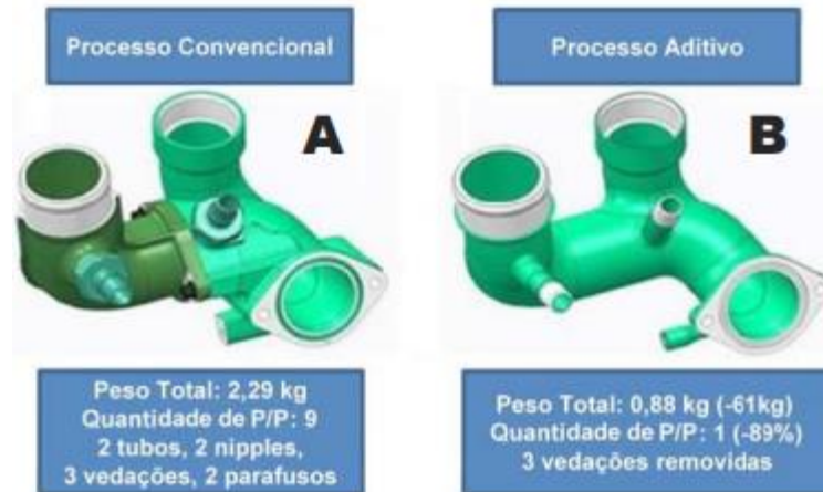
Figura 3- Comparação entre manufatura subtrativa (A) e manufatura aditiva (B).
