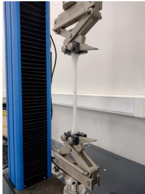
Figura 7 - Ensaio mecânico de uma amostra de PLA.
