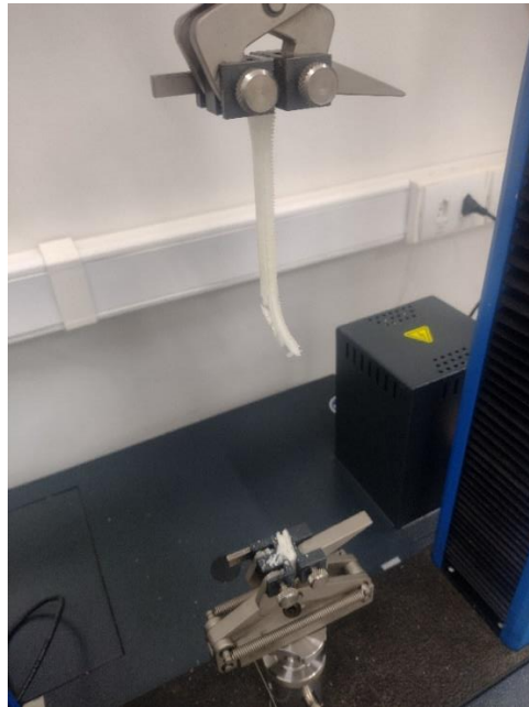
Figura 8 - Amostra de NYLON rompida a tração.
