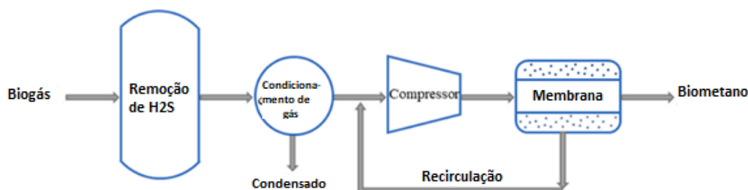
Figura 4 – Processo de purificação de biogás pelo método de separação por membrana.
