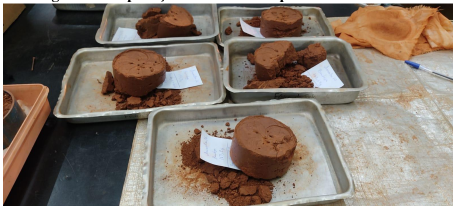
Figura 9. Preparação das amostras para destorroamento
