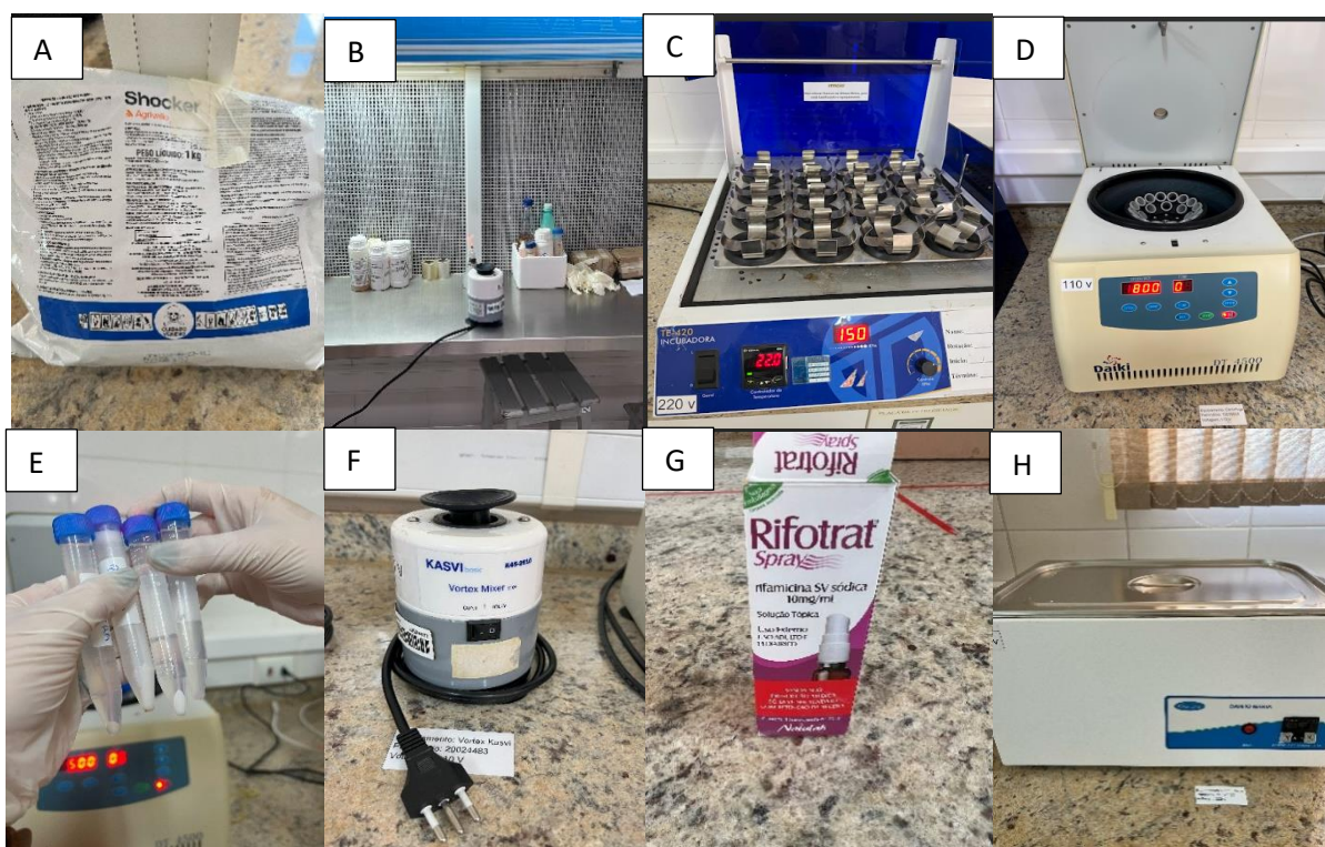
FIGURA 3: A – Shocker; B – Fluxo; C – Incubadora Shaker; D – Centrífuga; E – Peletização; F – Vortex; G – Rifotrat (antibiótico); H – Banho Maria.
