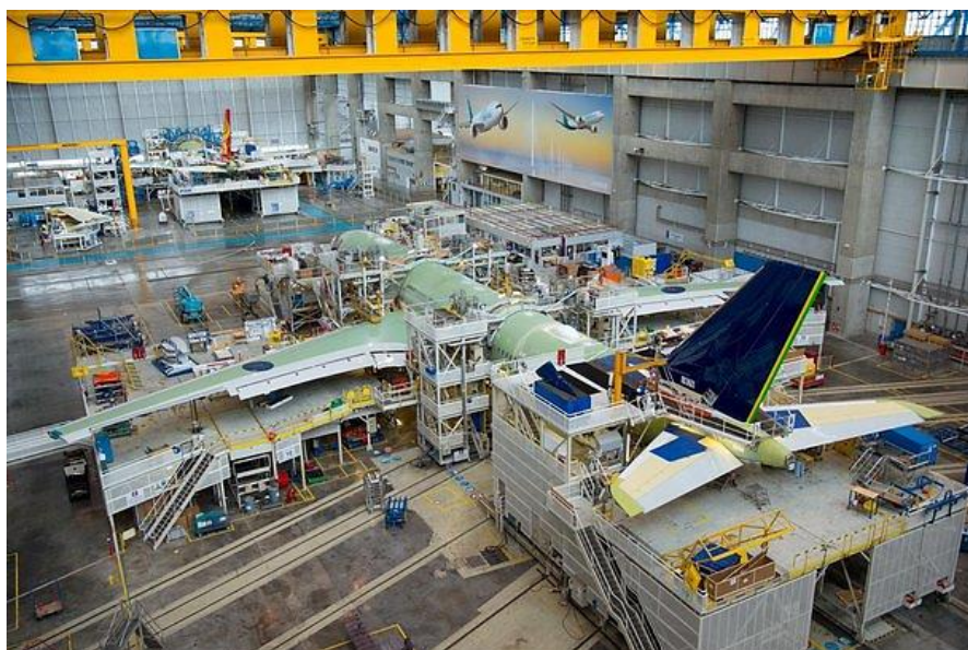
Figura 6 – Montagem de um avião (Exemplo de layout fixo).
