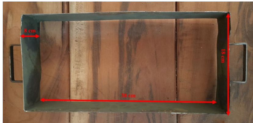
Figura 5 – Forma metálica utilizada na confecção.
