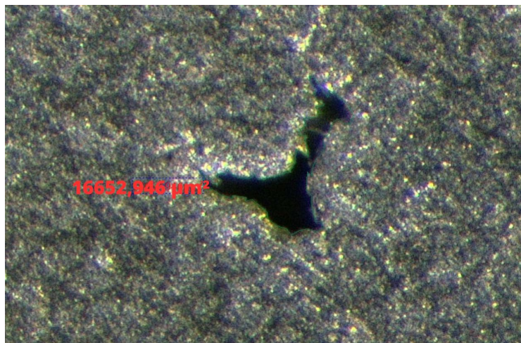
Figura 14 - Marcação de área do poro com ampliação pelo estereoscópio da amostra A0 - 3.
