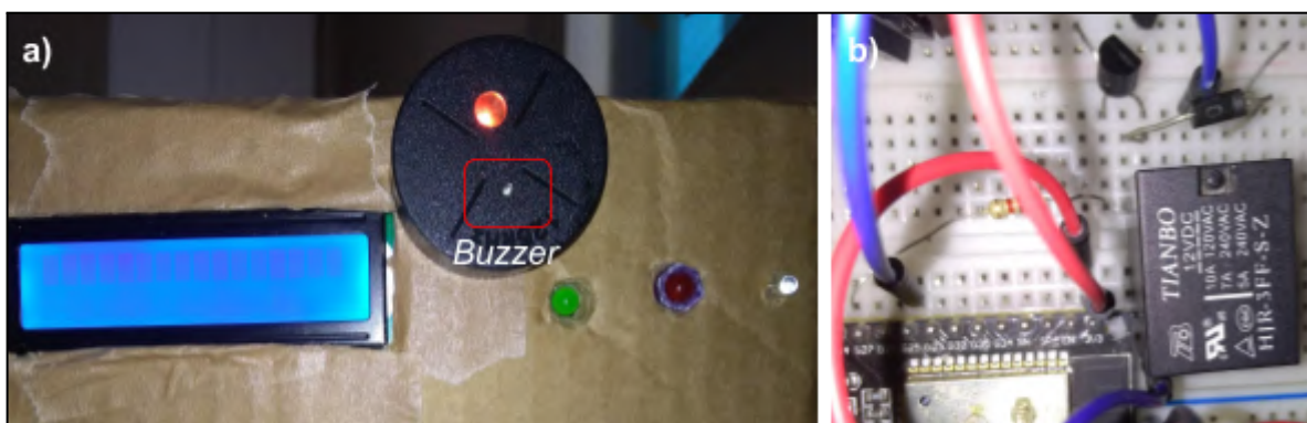
Figura 4.5 - Conexão dos atuadores na placa ESP32, onde a) buzzer , display LCD e LEDs e b) relé de bloqueio.
