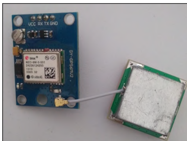
Figura 2.24. Módulo uBlox NEO 6M com antena.
