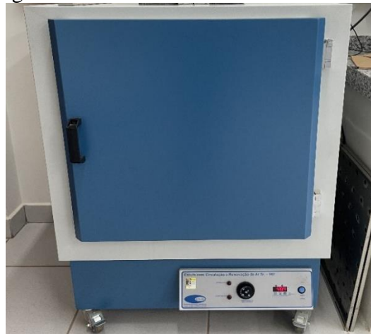
Figura 10 - Estufa SOLAB modelo SL-102.
