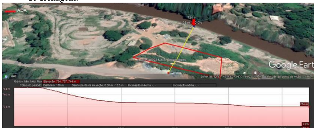
Figura 13 – Imagem extraída de PT demonstrando a declividade da área do aterro sem sistema de drenagem.
