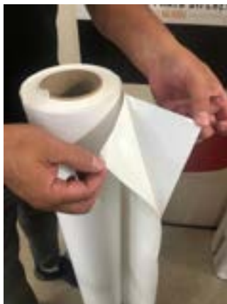
Figura 1 - Rolo de película adesiva de PVC e papel kraft siliconado utilizado na impressão.
