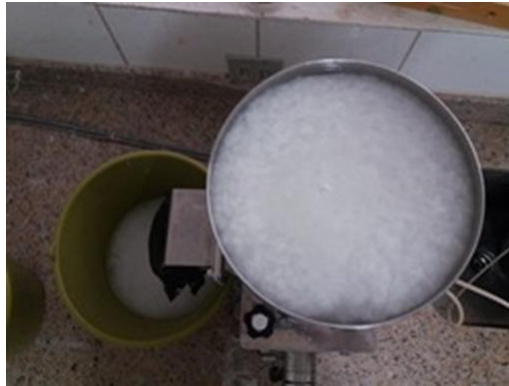
Figura 3. Obtenção de Nanofibrila de celulose pelo processo mecânico Grinder
