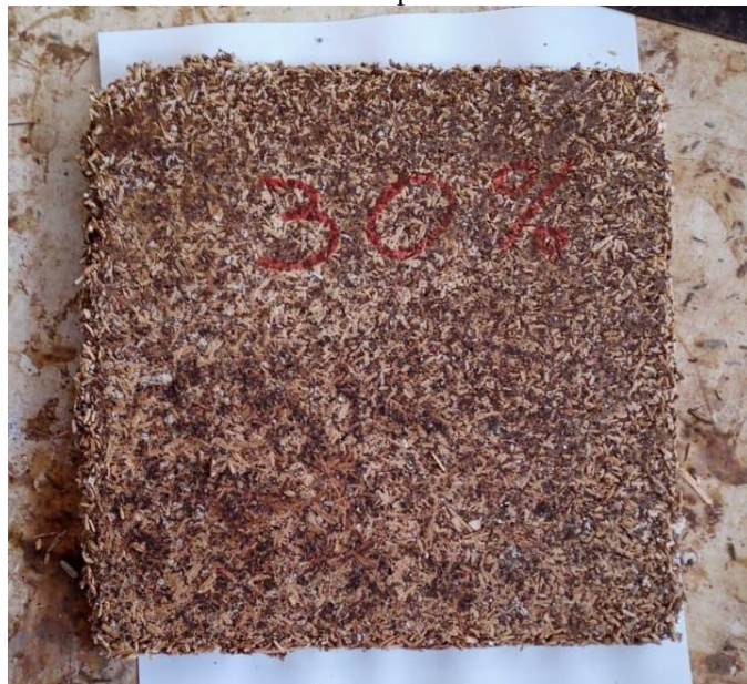
Figura 1 - Painel aglomerado constituído com 70% de partículas de madeira e 30% de resíduos de cigarro
