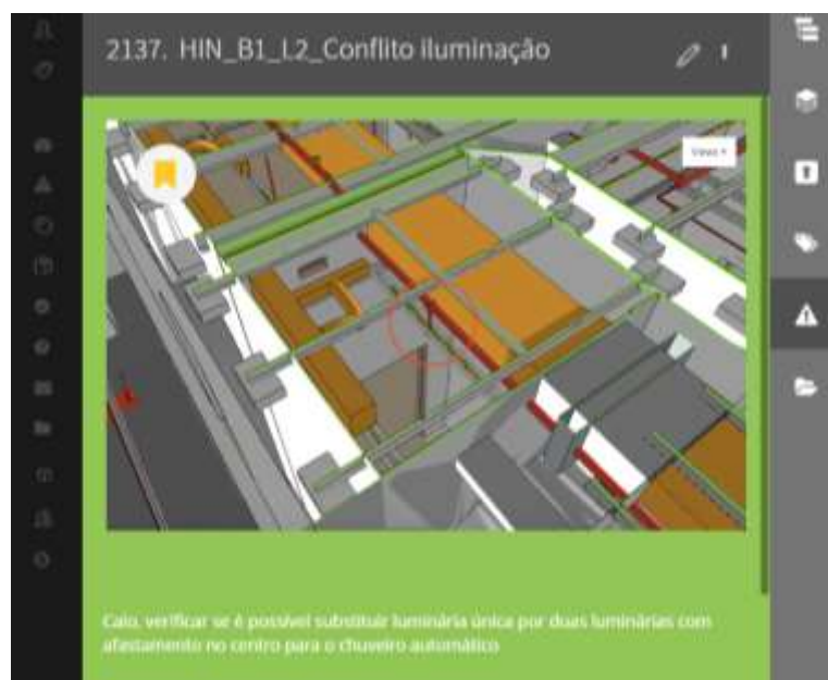
Figura 33 - Captura de tela da plataforma BIM Track- Exemplo de issue acerca de conflito entre chuveiro automático e luminária.
