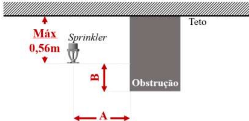
Figura 6 - Distâncias máximas a serem observadas no caso de obstrução, junto ao teto, de chuveiros automáticos, conforme estabelecido na ABNT NBR 10897:2020.
