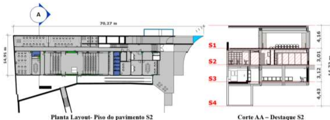
Figura 26 - Planta do pavimento S2 e corte esquemático com indicação dos pavimentos da edificação no Alípio.
