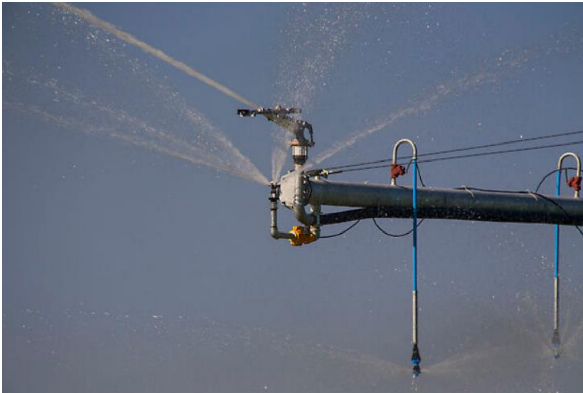
Fig. 2: Canhão final da linha lateral de um pivô central.
