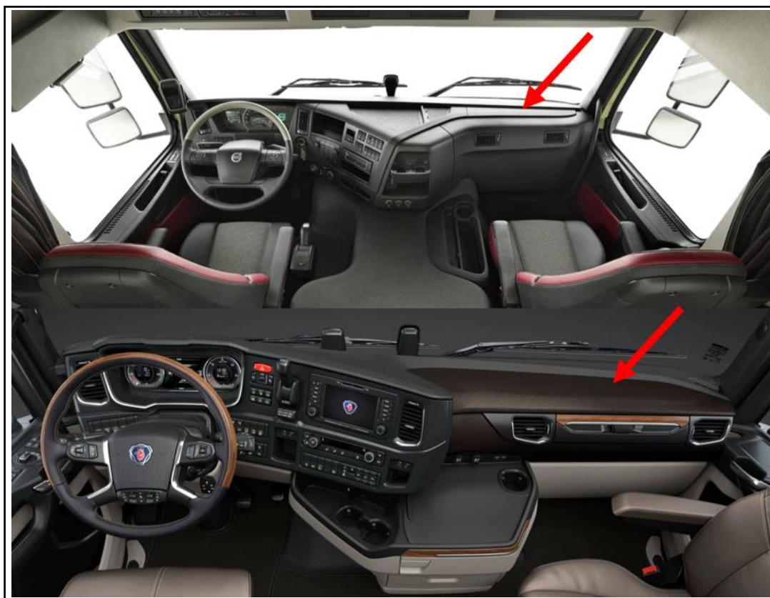
Figura 4.12 - Local de instalação do hardware do sistema IVMS, para todos veículos.
