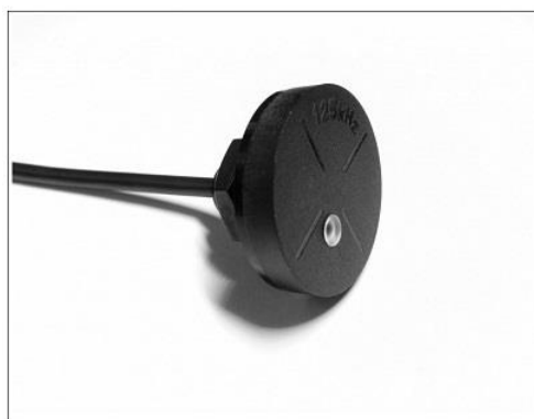
Figura 4.6 - Leitor RFID 125 kHz.
