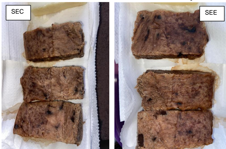
Figura 18 - Amostras esfoliantes acondicionadas no claro e escuro para Teste de Rachadura.
