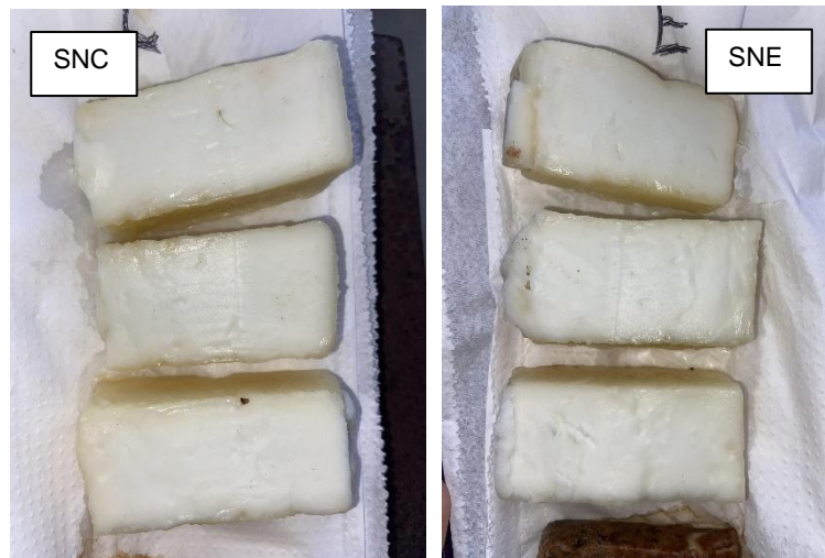
Figura 17 - Amostras normais acondicionadas no claro e escuro para Teste de Rachadura.
