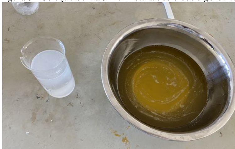
Figura 5 - Solução de NaOH e mistura dos óleos e gorduras.
