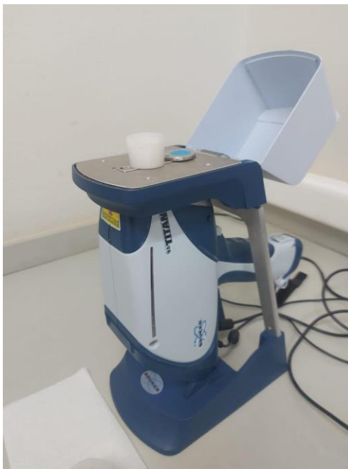
Figura 2: Equipamento espectrometria de fluorescência de raio-X utilizado.
