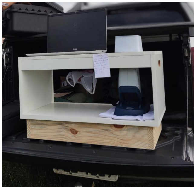
Figura 3: Estrutura utilizada para leitura via pXRF diretamente em campo.
