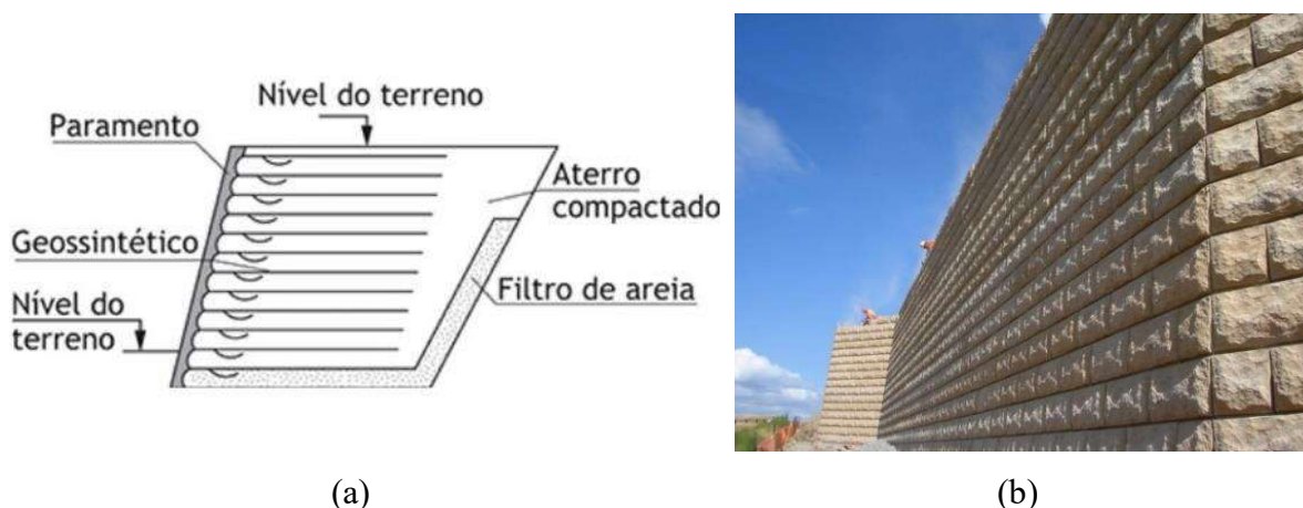
Figura 2.11 – Muro de solo reforçado: a) Seção transversal; b) Muro de solo reforçado
