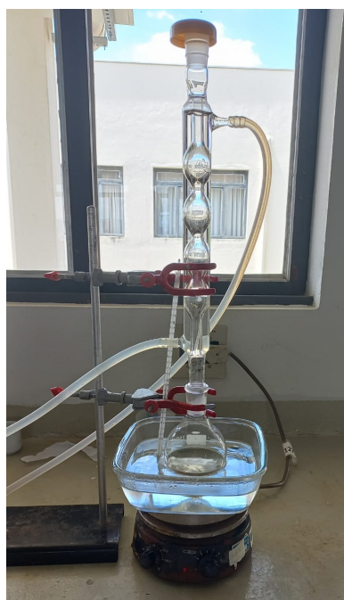
Figura 4.3 – Sistema de refluxo em banho-maria.
