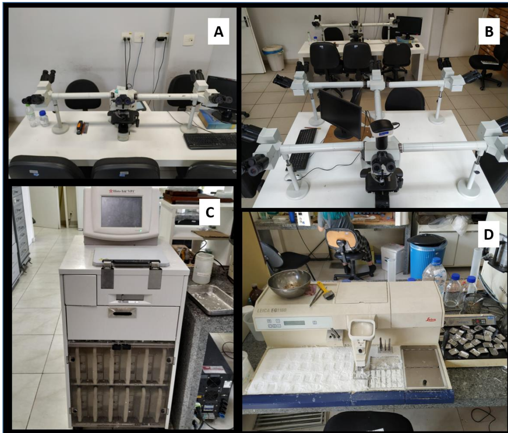
(A) Microscópio com extensor para cinco observadores. (B) Microscópio com extensor para dez observadores. (C) Processador automático de tecidos. (D) Central de Inclusão. Fonte: do Autor, 2022.
