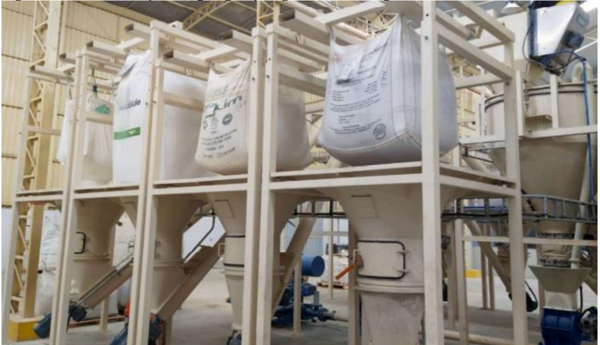
Figura 2 - Estrutura de porta big-bags e pesagem de macroingredientes.
