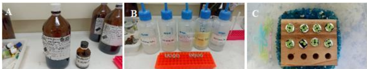
Figura 2 - Preparação para observação em microscópio eletrônico de varredura (MEV). (A) Karnovsky (pH 7,2) e tampão cacodilato 0,05M; Série de acetona para desidratação; (C) Stubs.
