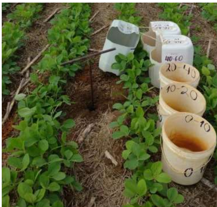
Figura 6 – Trado holandês usado para amostragem de solo.
