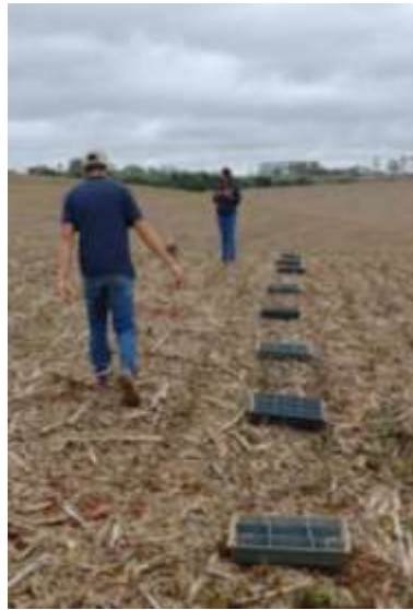
Figura 8 – Aferição do implemento Hercules para distribuição de adubo a lanço, teste de distribuição do adubo.
