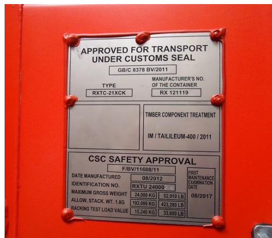
Figura 11 - Placa de identificação do container.
