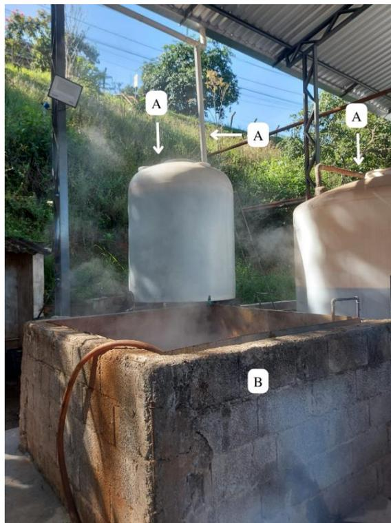
As setas com a letra A indicam o encanamento específico para recebimento de MP líquidas do setor de inseticidas, bem como os tanques de armazenamento. A letra B sinaliza a estrutura do banho maria industrial. Fonte: da autora (2023).
