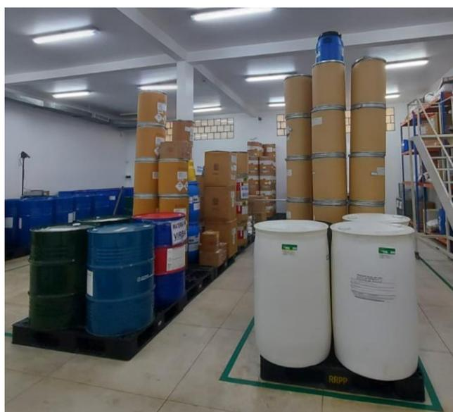
Maneira correta como cada área de produção armazena suas matérias primas. Os materiais encontram-se sobre *pallets* para evitar o contato direto com o chão, e não mantêm contato com as paredes. Fonte: da autora (2022).
