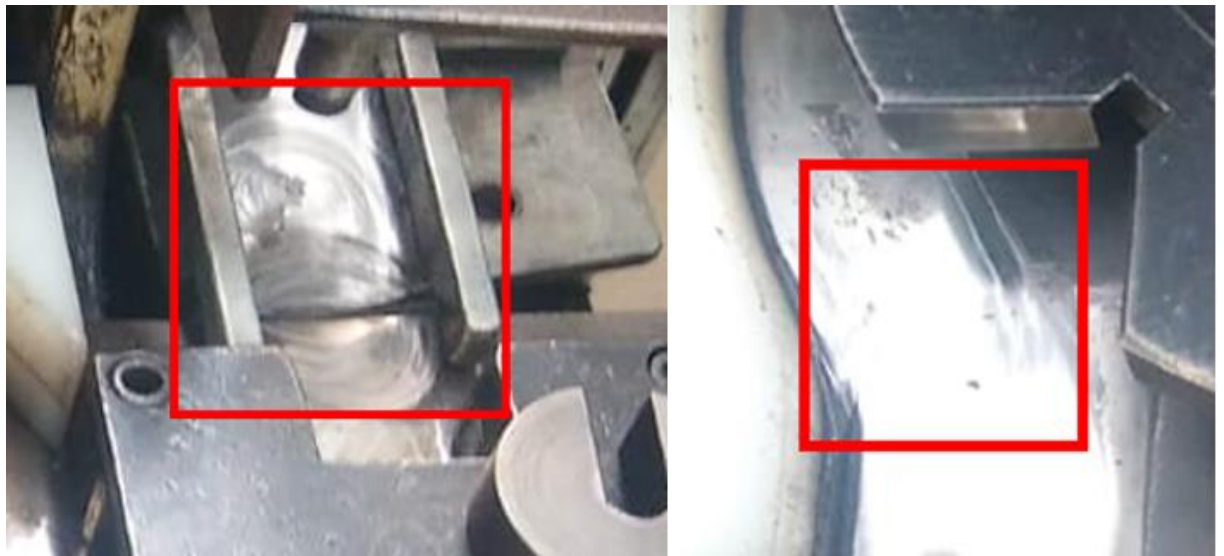
Figura 7 – Desgaste nas calhas do ferramental analisado
