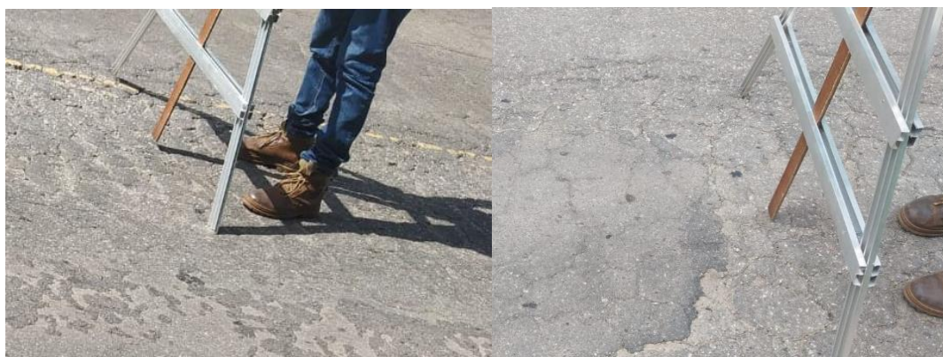
Figura 19 – Afrerição do afundamento da trilha de roda com auxílio de treliça metálica
