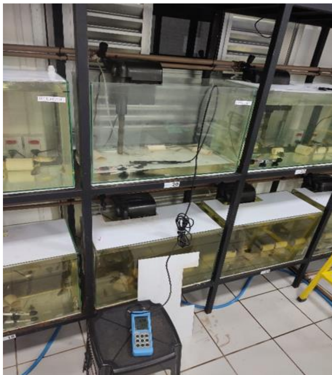
Figura 8 – Mensuração e controle da temperatura enquanto realizava a troca parcial da água.
