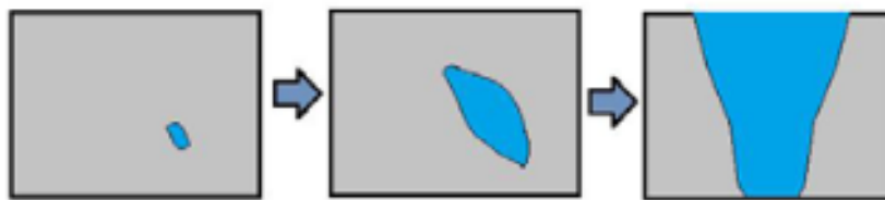
Figura 4 - Formação da brecha por piping .
