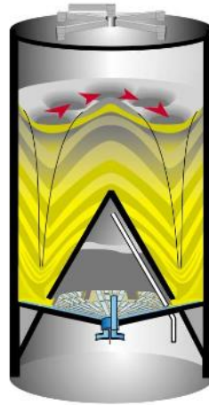
Figura 10 – Silo de homogeneização fluidizado.
