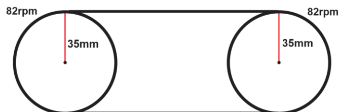
Figura 4.4 - Relação entre as polias utilizadas nos motores das esteiras
