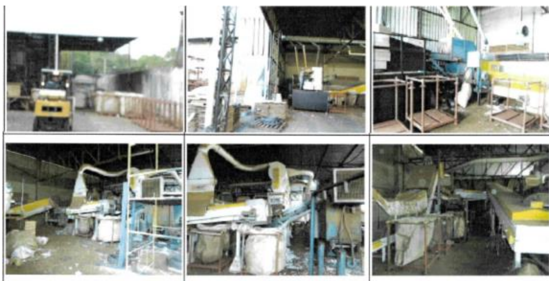
Figura 2.8 - Equipamento de destruição de maços de cigarros I
