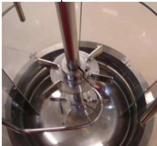
Figura 2 – Vista interna de um biorreator do tipo tanque agitado e aerado com impelidor do tipo Rushton.
