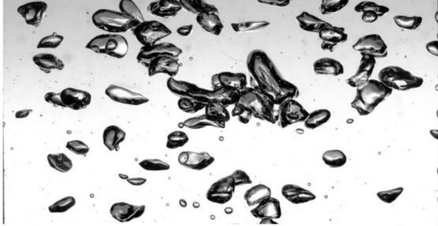
Figura 25 – Distribuição das bolhas no riser em y = 0,2 metros.
