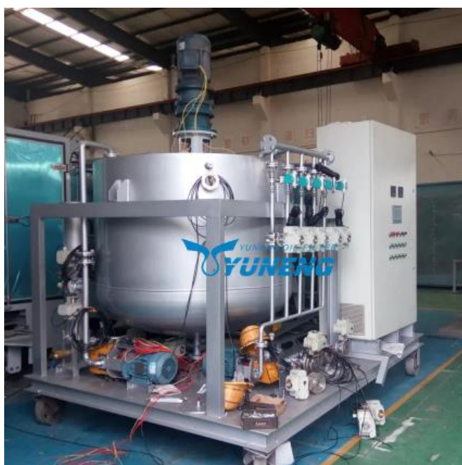
Figura 16 - Equipamento automático de mistura de óleo base aos aditivos.
