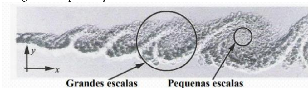
Figura 7 – Representação das escalas de turbulência em um escoamento.
