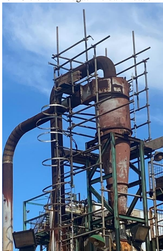
Figura 20 - Ciclone de Bagacilho da unidade industrial.
