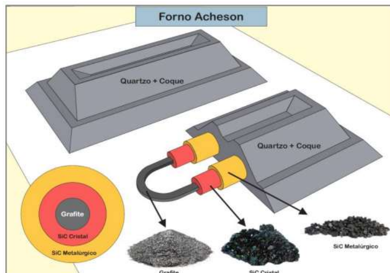
Figura 3 - Forno utilizado para a obtenção de carbeto de silício pelo processo Acheson .
