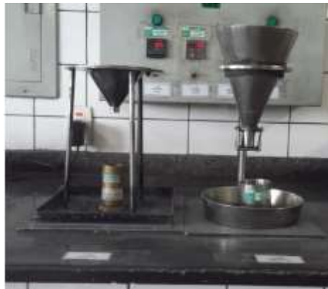
Figura 20 – Funil de Hall para medição de densidade aparente.
