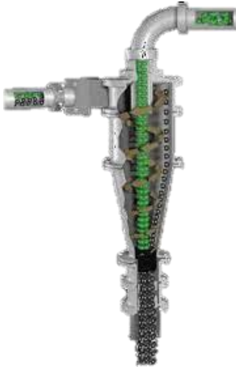
Figura 14 - Perfil em corte de um hidrociclone
