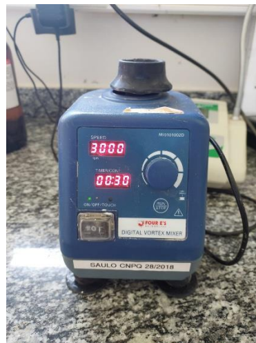
Figura 5: Vórtex mixer utilizado para remoção das bolhas e homogeneização das amostras no molde.
