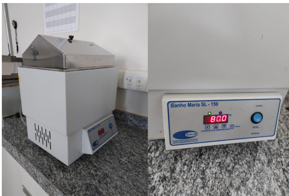
Figura 6: Máquina de banho maria fixada a 80°C utilizada para realização da cura térmica.
