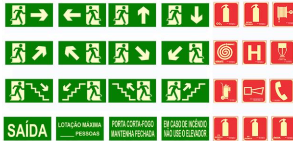
Figura 24 - Exemplo de sinalização de emergência
