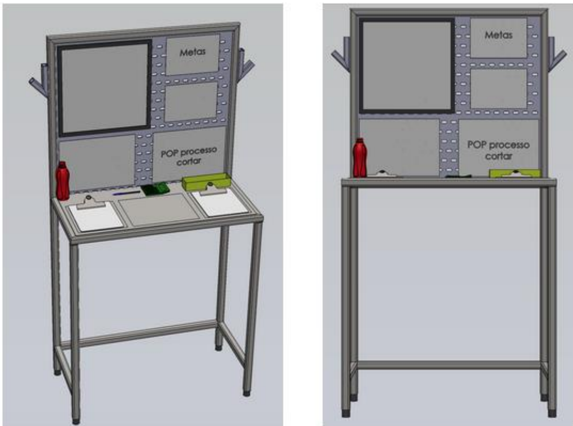
Figura 21 - Bancada principal – Vista em perspectiva e frontal
