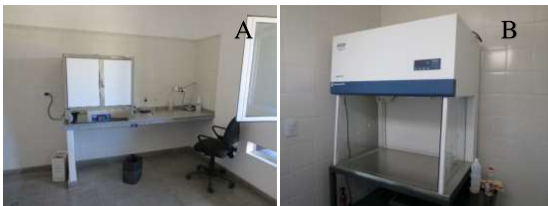
Estufa de precisão ( San Jor ® , serie SLDB , Argentina ) (A) e capela de fluxo laminar ( ISOCIDE ® , Argentina ) (B). Fonte: da autora (2023).
