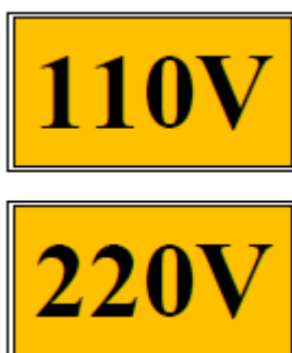
Figura 18 - Identificação de tensão de tomadas.
