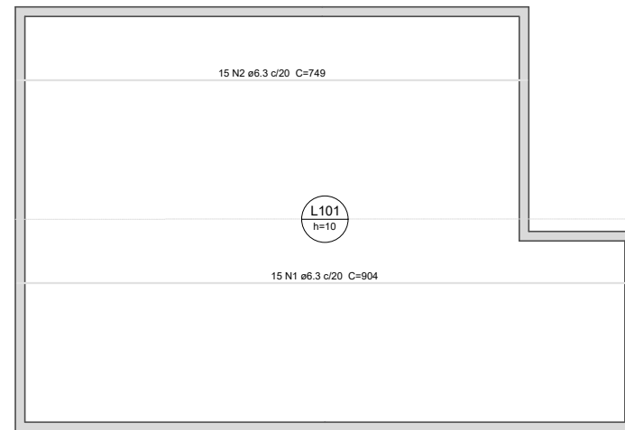
Armação inferior do radier do pavimento Térreo (Eixo X) escala 1:50
