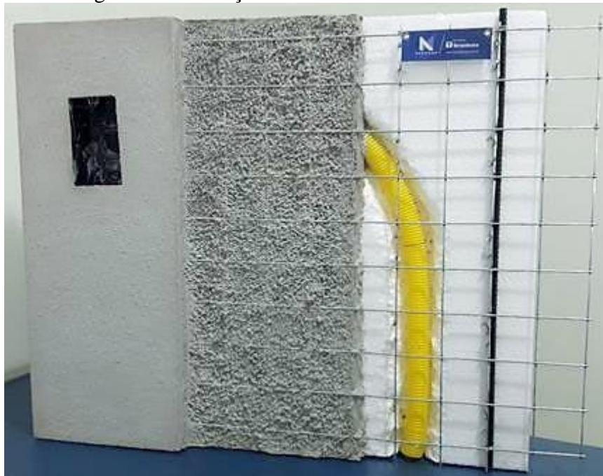
Figura 7 – Instalações elétricas no sistema em EPS.
