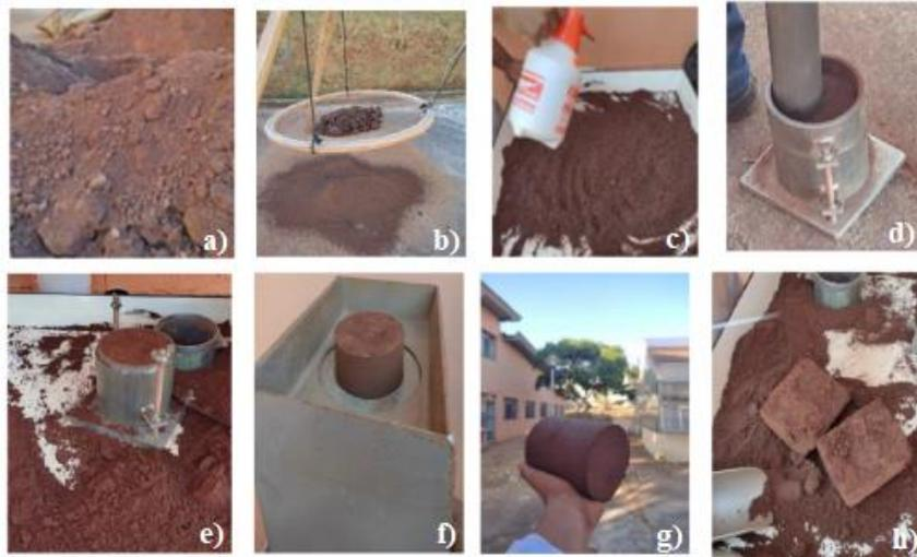
a) Preparação da mistura. b) Peneiramento. c) Umidificação do solo. d) Preparação do corpo de prova. e) Corpo de prova no molde. f) Pesagem do corpo de prova. g) Corpo de prova. h) Corpo de prova pós ensaio.
