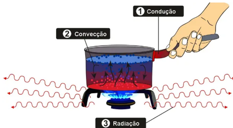
Figura 1 - Mecanismos de transferência de calor.
