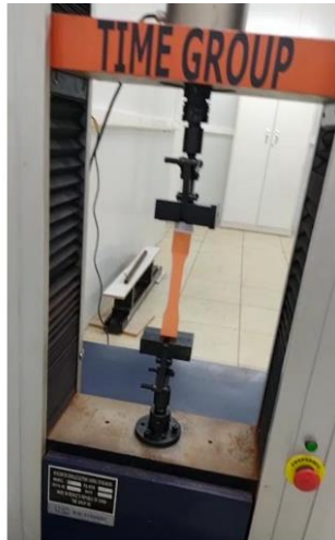
Figura 16- Ensaio de tração na Máquina Universal de Ensaio.
