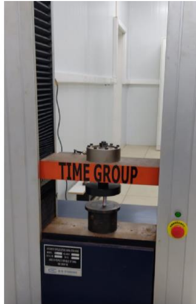
Figura 18- Ensaio de compressão utilizando uma Máquina Universal de Ensaios.
