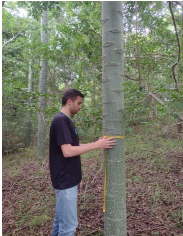
Figura 3 - Utilização da fita métrica em campo para avaliação da circunferência na altura de 1,30 m.
