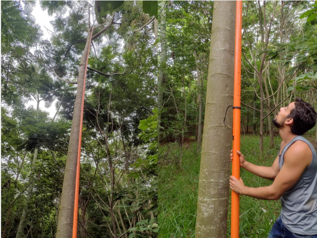
Figura 2 - Utilização da régua graduada em campo para avaliação da altura.
